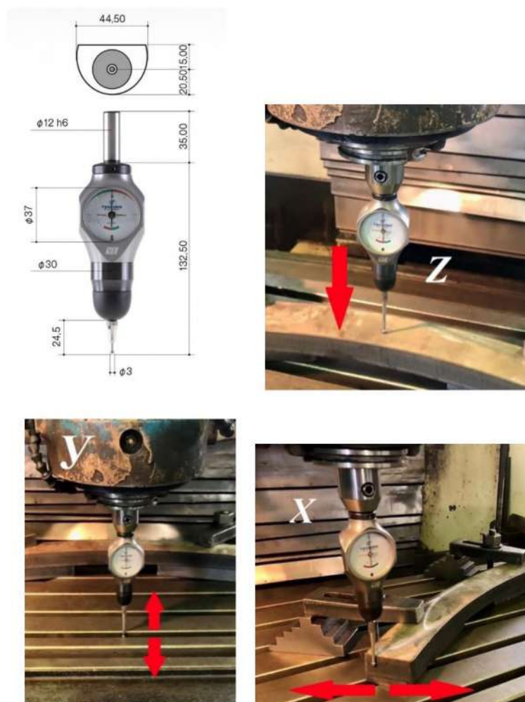
Рис. 1.16 Визначення нульової точки сенсорним індикатором
