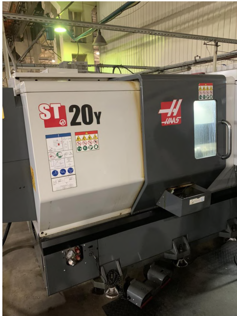
Рис. 2.2. Токарний центр з ЧПК HAAS ST 20
