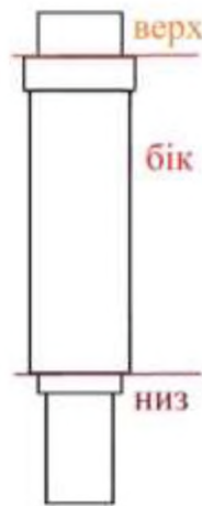
Рис. 2.2.Схема визначення припусків і допуску.
