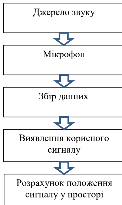
Рис. 1 – Типова схема програмно-апаратного комплексу для виявлення БПЛА
