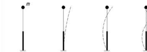
Рис.2 – Розрахункова схема та три власні форми коливань баштових споруд
