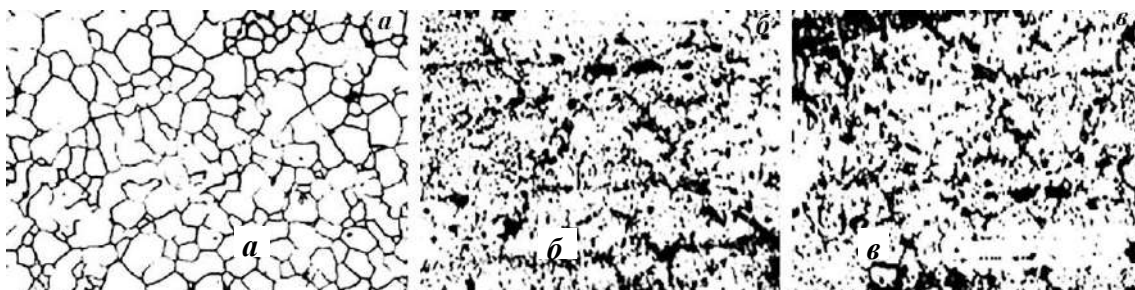
Рис. 5 – Мікроавторадіограми заліза ( ^{55}\text{Fe} ) після УЗ обробки з нагрівом ( \varepsilon_m = 1,3 \cdot 10^{-4} , T = 773 \text{ K} ), \times 70 , та заліза після дифузії в нього вуглецю ^{14}\text{C} при нагріві ( a ) та нагріві з ультразвуком ( б ) (1073 K, 30 кГц), \times 150 .
